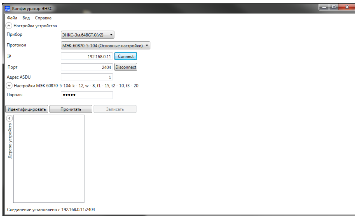
Рисунок 4.2. Организация подключения к ЭНКС-3м через Ethernet.
